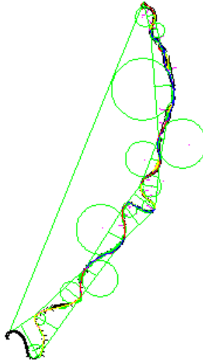
شكل ( ٤ ) يوضح طريقة قياس أبعاد الثنيات النهرية .
